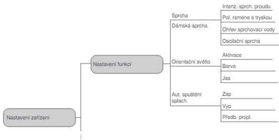
**i** Menu [Autom. spuštění splachování] se objeví jen tehdy, když je nainstalován volitelně dostupný modul rozhraní k externímu spuštění splachování.
