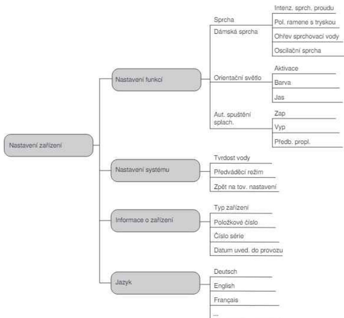
**i** Menu [Autom. spuštění splachování] se objeví jen tehdy, když je nainstalován volitelně dostupný modul rozhraní k externímu spuštění splachování.
