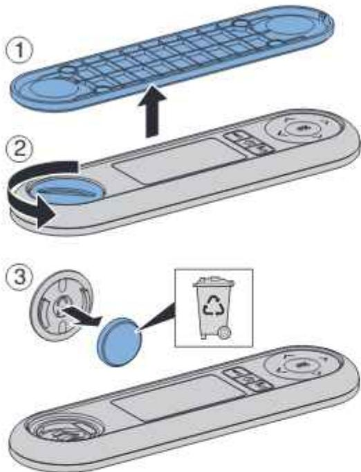
**2** Vložte novou baterii typu CR2032.
